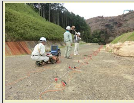
高密度表面波探査 測定状況
